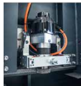
Accoppiamento pignone e cremagliera Pinion and rack connection
