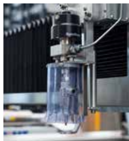
Tastatore asse z Height control z axis
