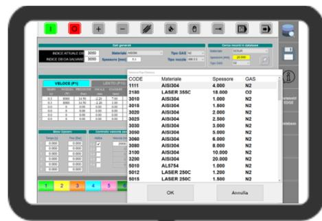
Caricamento parametri di taglio da data base tecnologico interno.
