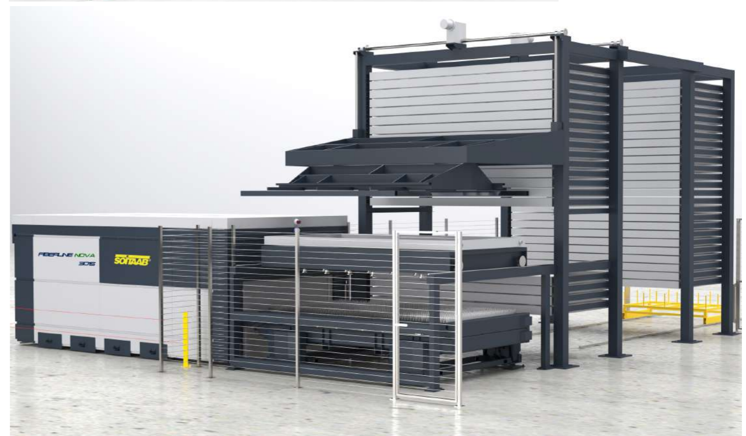
Magazzino automatico massivo per lamiera. Uno o più torri, con portate da 3000 a 6000 kg. Dimensioni 1530, 2040, 2060, 2560.
