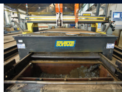
Raschiatori per la pulizia automatica sotto banco supporto lamiera
