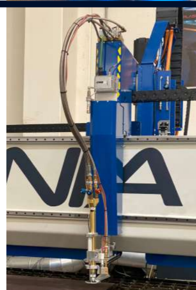
Cannelli Ossitaglio con capacitivo e anello di testatura esterni
