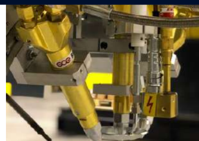
Testa bevel 3 cannelli ossitaglio a rotazione manuale o automatica
