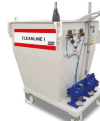
Sistema di rimozione abrasivo manuale Il sistema mobile di spurgo CLEANLINE rimuove gli accumuli di sabbia dal recipiente di taglio durante le operazioni di taglio. Il sistema CLEANLINE richiede unicamente aria compressa e può dunque essere utilizzato in qualsiasi luogo senza alcun rischio di cortocircuito. Spurgo efficiente. Estrazione e scarico in un'unica operazione. Pompa specializzata per una lunga durata operativa. Manutenzione minima.
